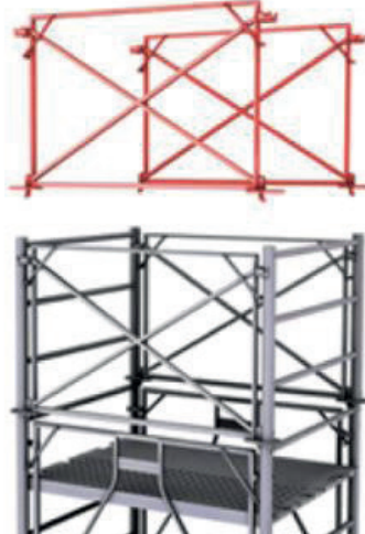
MONTAGE DEPUIS LE PLANCHER COMPLET (SÉCURITÉ)
