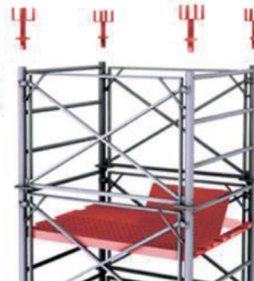
MONTAGE DEPUIS LE DERNIER PLANCHER COMPLET (À TRAPPE ET PLATEAUX DE MONTAGE)
